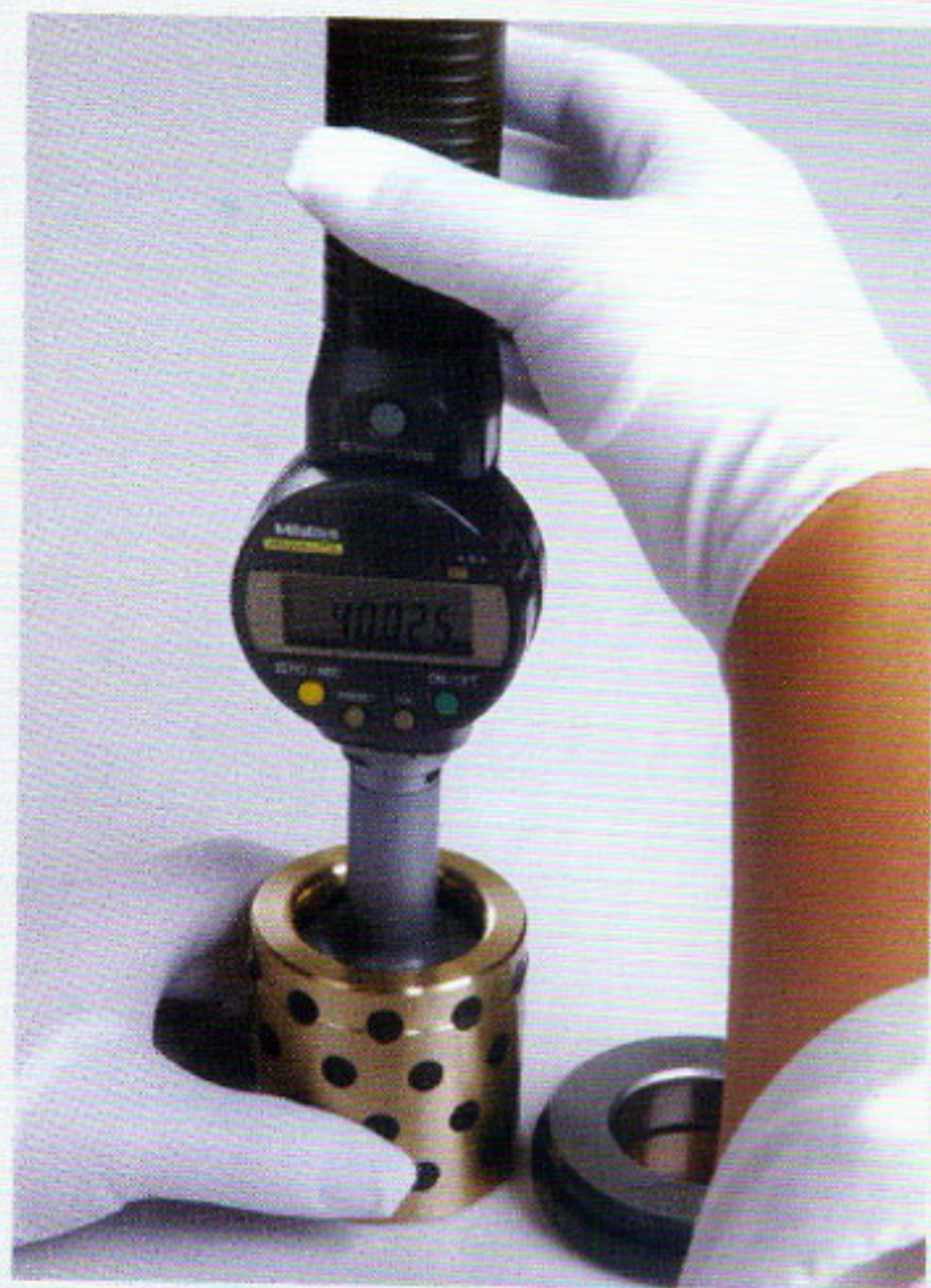
内径数显千分尺检测内径 Check ID by ID micrometer
