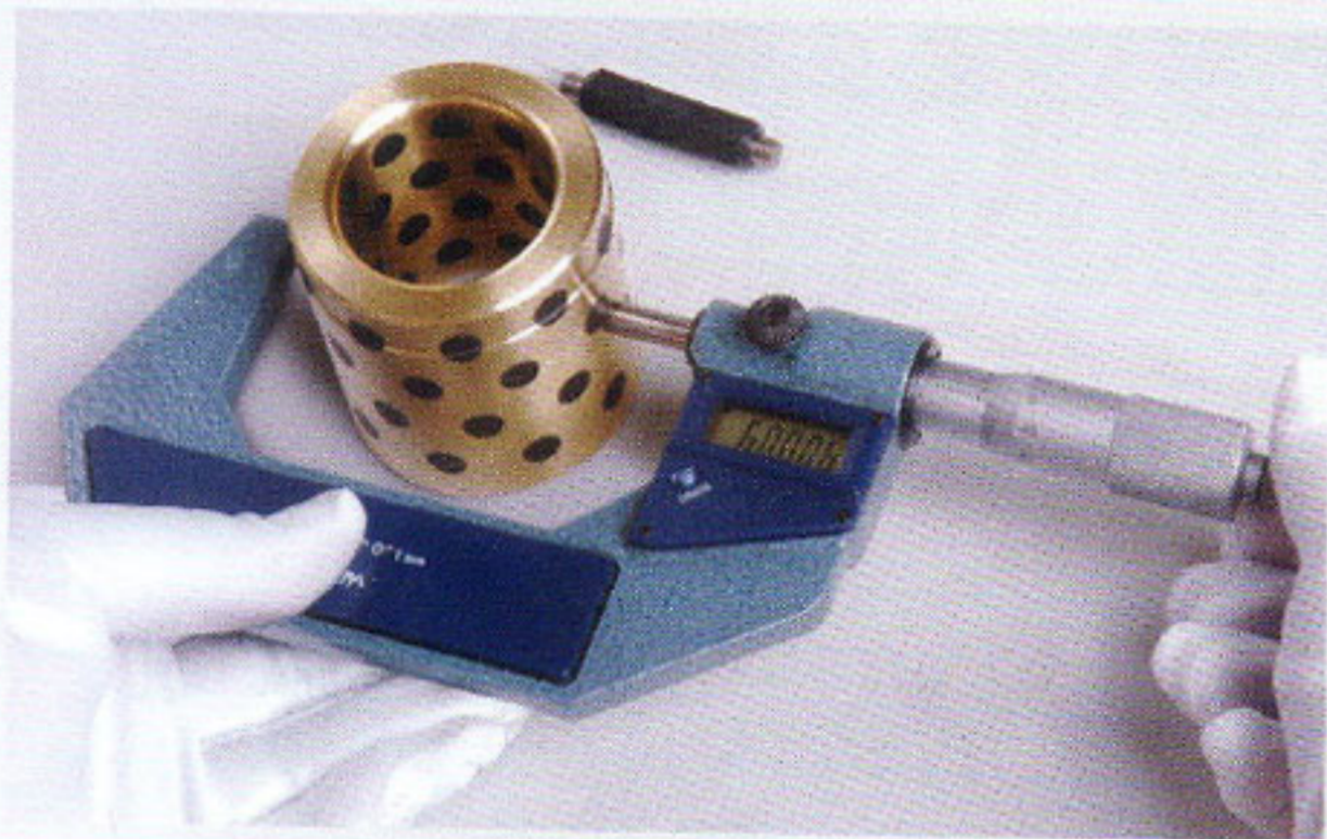
外径千分尺检测外径 Check OD by OD micrometer
